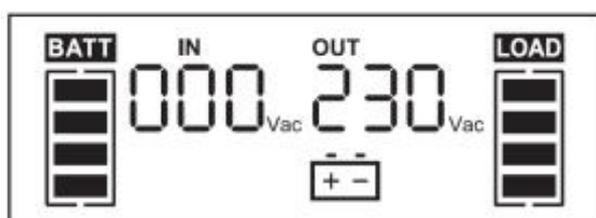
Fig. 11. Monitor em modo baterias.
