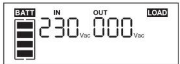
Fig. 12. Monitor em modo de carregador de baterias.
